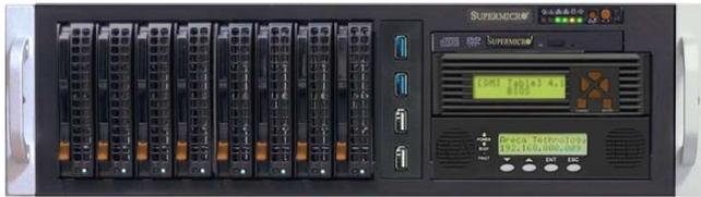
フロント(LCD&RAID コントローラ, USB オプション実装時)
