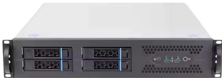
フロント(エアフィルター装備) 4*2.5/3.5 インチ 6G SATA Hot Swap Bay, 2*USB 3.0 Type-A Port
